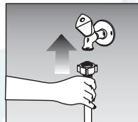
Не подключайте машину с одним шлангом подачи воды к горячей воде. Если машина подключена Y частью к двум шлангам подачи воды и для машин с одним шлангом подачи воды температура воды будет более 40°C, машина может переключиться на защитный режим.
